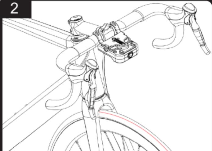
Schalten Sie Ihren Staystraight ein und drehen Sie Ihre Lenker, bis die projizierte Laserlinie parallel zur Mittelnaht Ihres Reifens verläuft. Wenn der Strahl parallel zu einer der Profillinien verläuft, ist Ihr Lenker ausgerichtet. Ziehen Sie die Vorbauschrauben an und entfernen Sie den Staystraight.
