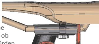
**SCHRITT 2:** Halten Sie den Sattelstützenadapter fest in den Klemmbacken und setzen Sie die Sattelschienenhaken auf die Sattelschienen. Achten Sie darauf, dass die Haken flach an der Sattelstützenklemme anliegen. Dadurch wird sichergestellt, dass das Gerät ohne Spiel fixiert ist.
