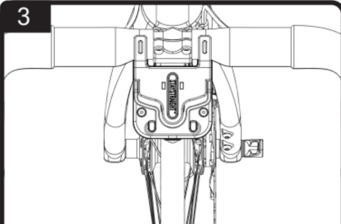
Quando si usa su un manubrio conico, è fondamentale assicurarsi che lo Staystraight abbia una distanza uguale tra l'attacco e le ganasce per posizionare la linea laser sul piano centrale del pneumatico.
