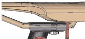
**FASE 2:** Con l'adattatore del reggisella saldamente fissato con le pinze di bloccaggio, posizionare i ganci della guida della sella sulle guide, assicurandosi che i ganci siano piatti contro il blocco del reggisella.
